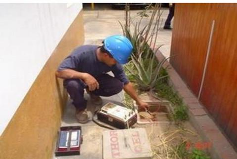
Para una acción eficaz, resulta primordial que la resistencia de puesta a tierra tome un valor tal que no origine tensiones peligrosas al circular la corriente de falla; por lo que su valor está perfectamente acotado por las normas de aplicación para los distintos tipos de instalaciones.
